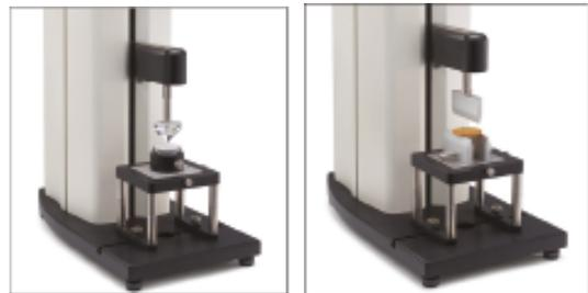
\*Velocidad máxima de prueba para 100kg = 10mm/s y 50kg = 20mm/s.
