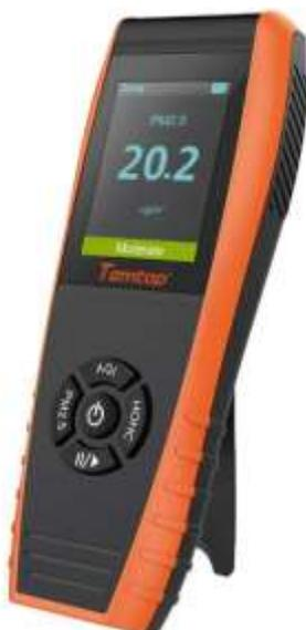
Los detectores de la serie LKC-1000 pueden detectar con precisión la calidad del aire mediante su sensor electroquímico de formaldehído de alta precisión y su sensor laser de partículas. Al mostrar la concentración de contaminantes del aire en datos intuitivos, los detectores también permiten guardar y exportar datos históricos. Adecuados para diversos entornos, escuelas, oficina, automóviles, entre otros.
