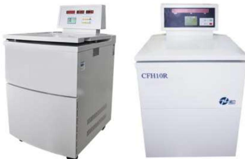
Las centrifugas para petróleo están diseñadas para la determinación de agua y depósitos en petróleo crudo. Utiliza la separación centrífuga para determinar la cantidad de agua y depósitos en petróleo crudo. Es el equipo ideal para determinar la humedad en la industria de exploración petrolera e instituto de investigación.
