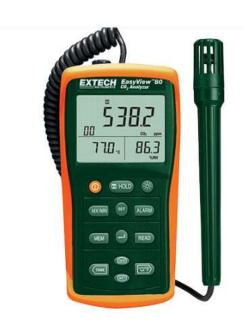
Permite la medición de C02, temperatura, humedad, punto de rocío y bulbo húmedo. Registra datos automáticamente hasta 20,000 conjuntos o almacena/recupera manualmente hasta 99 conjuntos
