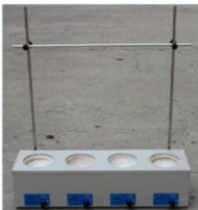
La manta de calentamiento es un equipo de laboratorio, que se usa para suministrar una temperatura estable de forma uniforme y segura a los diversos recipientes cuya base sea redondeada, como los balones volumétricos.
